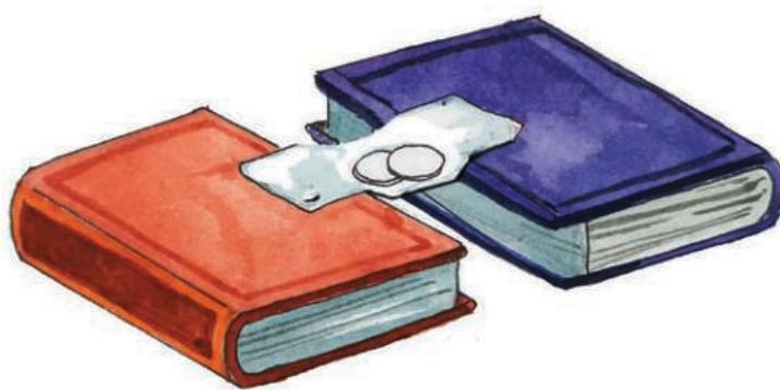
अनुमान लगाओ कि यह पुल 1 रुपए के कितने सिक्कों का भार उठा पाएगा? करके देखो। क्या हुआ? पुल एक भी सिक्के का भार नहीं उठा पाया? अब कागज को चित्र में दिखाए तरीके से मोड़ो। अब यह नया पुल कितने सिक्कों का भार उठा पाएगा?
