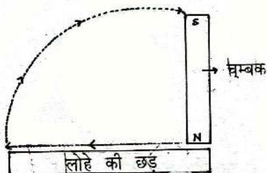
उपरोक्त चित्र में लोहे की छड़ी को चुम्बक बनाने की विधि दी गई है। लोहे की छड़ी के चुम्बक बनाने पर उसके ध्रुव उपरोक्त चित्र में अंकित करो।
